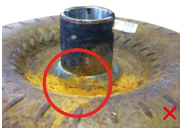
Těžká koroze (zejména na náboji)
