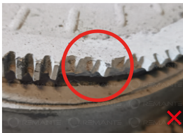
Poškozené ozubené kolo
