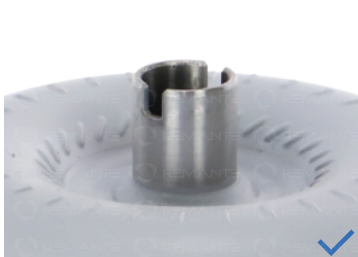
Bez poškození náboje a těla dílu
