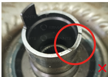
Těžká koroze (zejména na náboji)
