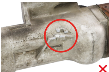
Poškozené držáky šroubů
