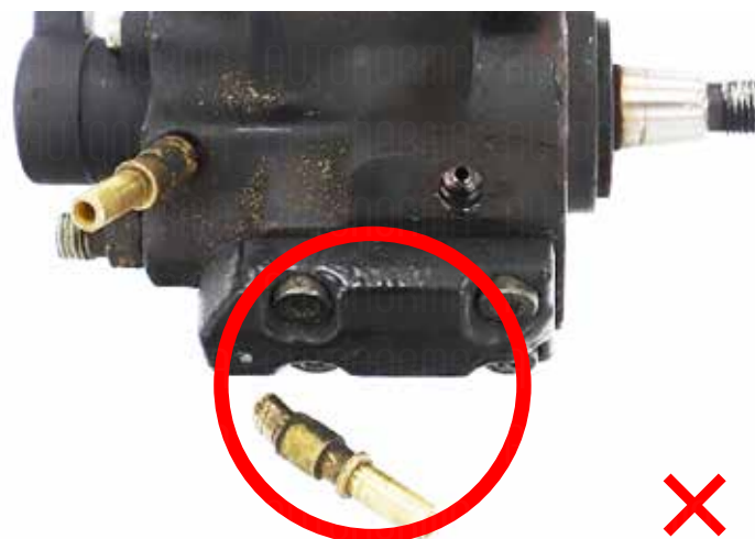
Poškozený palivový přívod
