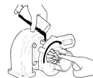
**7** Zkontrolujte, zda není poškozeno přívodní vedení mazacího oleje (poškozené, ucpané). Doporučujeme vyměnit přívodní i vratné vedení oleje za nové (dle originálního výrobce).
