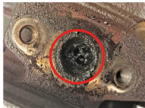
**Ucpaná olejová příruba** – karbonizované částice oleje z motorového oleje v důsledku zanedbané údržby. Nadměrné usazeniny motoru nebo zbylá těsnící hmota.
