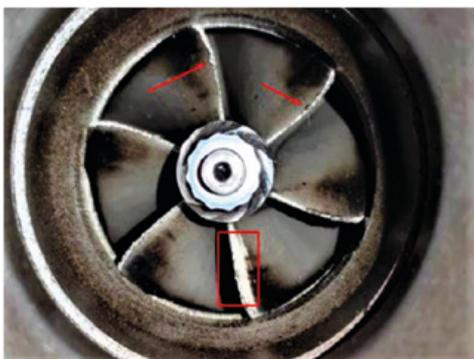
**Poškozené břity kompresorového kola** – způsobené částicemi v sání v důsledku nečistot.
