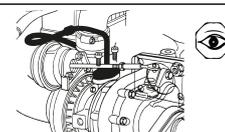
**8** Po montáži turbodmychadla nastartujte motor a zkontrolujte těsnost spojů.
