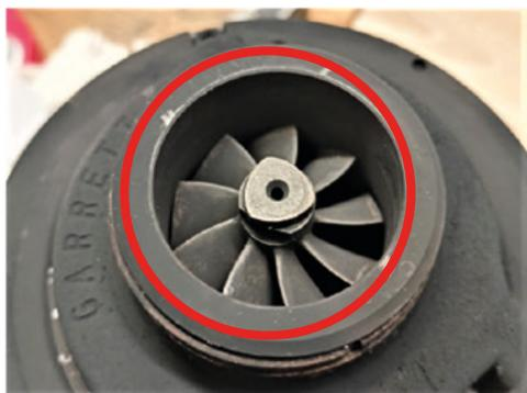
**Nedostatečný přívod oleje k rotoru turbodmychadla** – poškození turbínového kola a skříňě turbíny způsobené axiální nebo radiální vůlí v důsledku nedostatečného mazání rotoru turbodmychadla.
