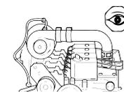
**6** Před instalací turbodmychadla zkontrolujte, zda jsou všechna potrubí řádně vyčištěna a zda v nich nejsou žádné částice. Před připojením turbodmychadla k motoru **aplikujte olej (přiložen v balení) do ložiskového středu a několikrát otočte rotorem. NEPOUŽÍVEJTE tmel.**
