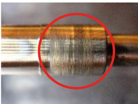
**Nedostatečný přívod oleje k rotoru turbodmychadla** – poškození rotoru turbíny způsobené nedostatečným mazáním.
